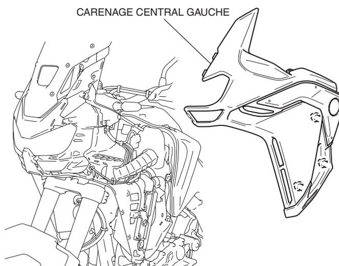
6. Déposez le carénage central droit de la même manière que sur le côté gauche.
