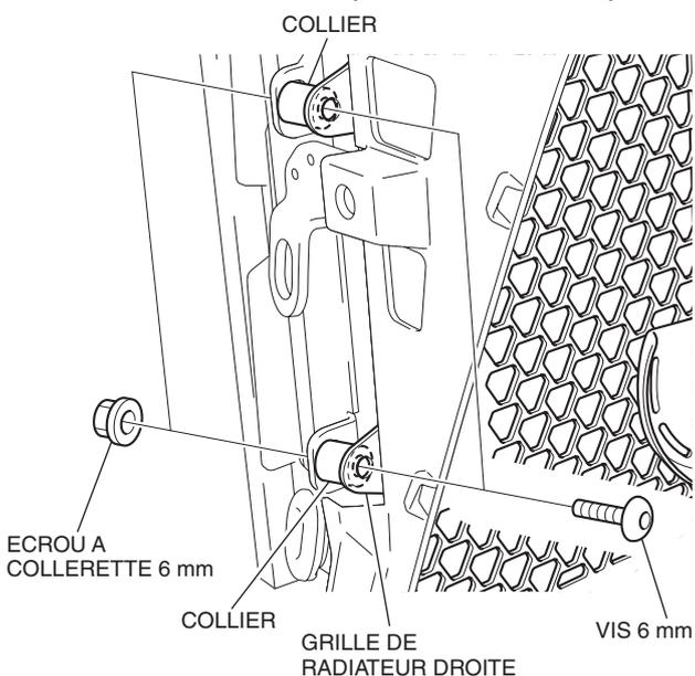
16. Serrez à fond les pièces partiellement serrées.
